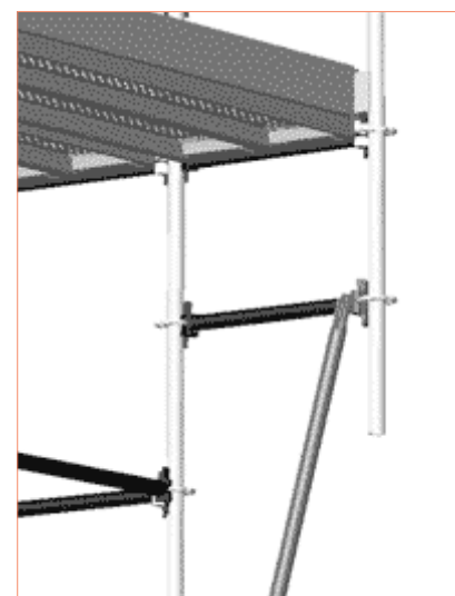
Rys. 3.29 – Rozszerzenie za pomocą rygli i stężeń
