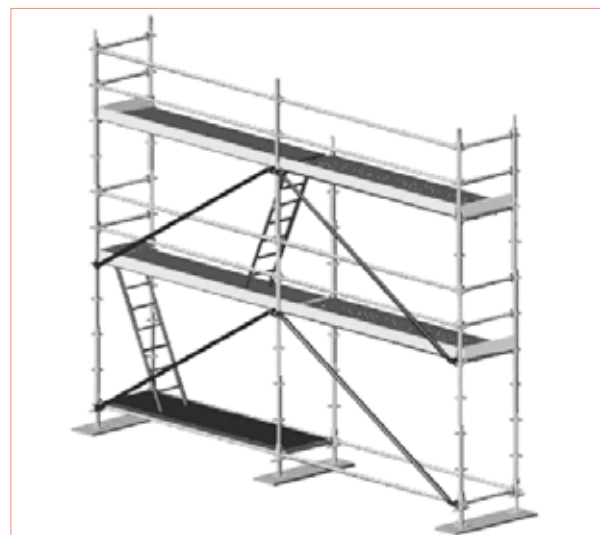
Rys. 3.23 – Przykład rusztowania z zabezpieczeniem bocznym
