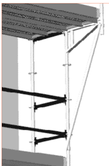
Rys. 3.28 – Rozszerzenie za pomocą wspornika 0,73 m i stężenia
