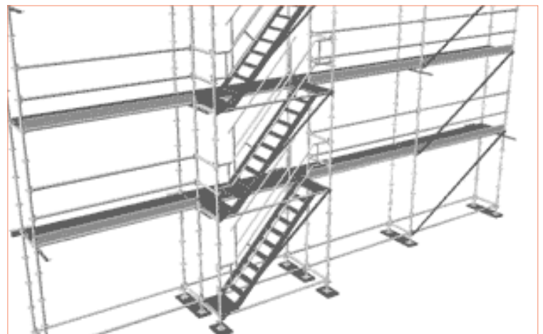
Rys. 3.76 – Zewnętrzna klatka schodowa jednozabiegowa
