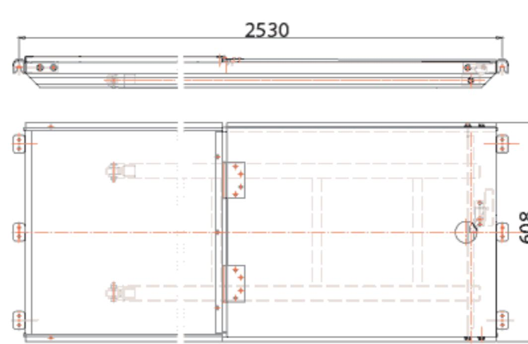
Pomost wyposażony jest w podwieszane drabinki, umożliwiające komunikację pionową wewnętrz rusztowania.
