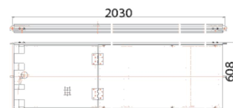
Pomost antypoślizgowy, powierzchnia pomostu wypełniona sklejką, klapa przejściowa aluminiowa.
