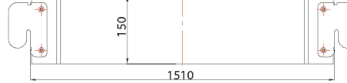
Element bezpieczeństwa, wykonany z drewna. Zawieszany na uchwytych, pomiędzy rurą pionową stojaka a klinem U-rygla. Montowany na wysokości pomostu, zabezpiecza przed upadkiem z wysokości.
