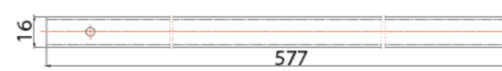
Sworzeń mocujący drabiny do ramy aluminiowej pomostu. Element serwisowy.
